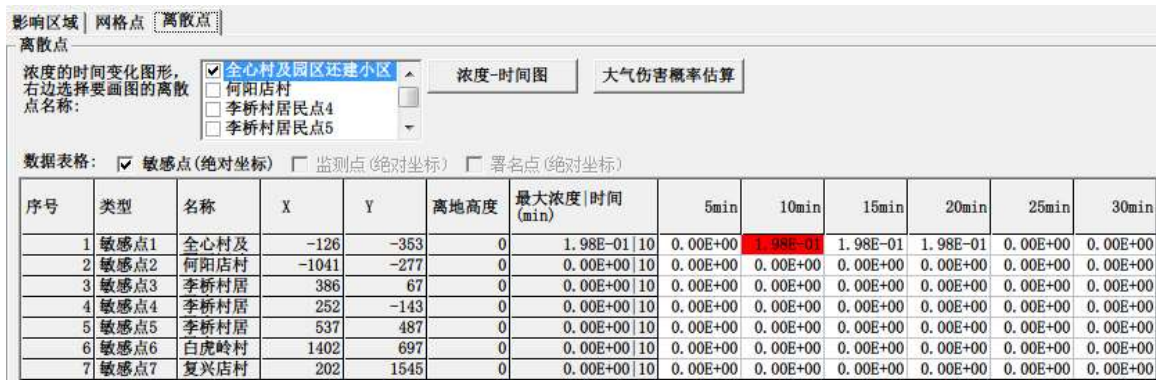
图7.6-43 最不利气象条件下CO泄露后离散点浓度-时间预测结果图
