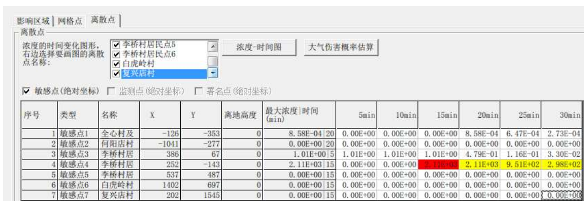
图7.6-19 最不利气象条件下环氧乙烷泄露后离散点浓度-时间预测结果图
