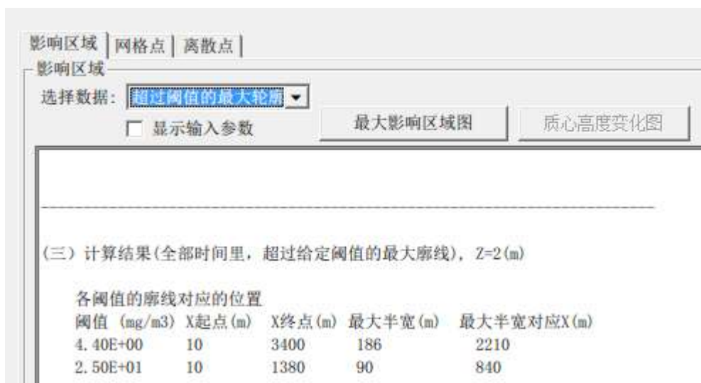
图7.6-28 最不利气象条件下氯磺酸泄露后阈值最大廓线预测结果图
